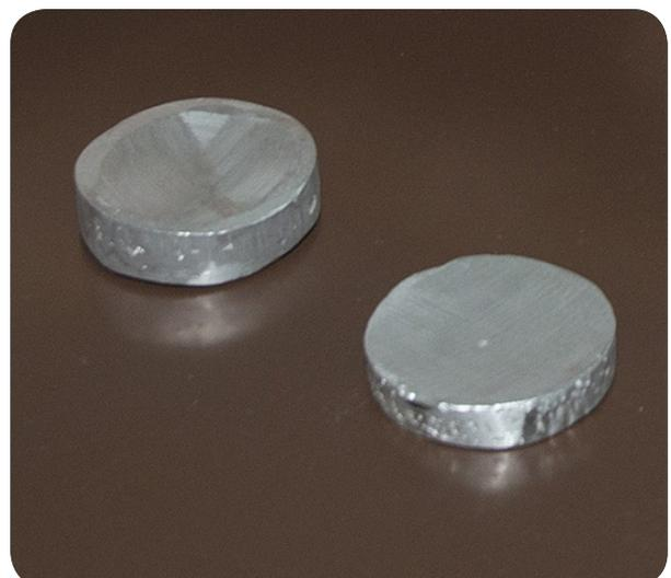
Photo n° 16 : plaques d'aluminium pour limiter le volume de l'hygromètre
