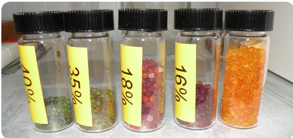
Photo n° 25 : échantillon étalon de Silica gel coloré
